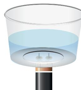
**5** Observe le résultat : des bulles de gaz apparaissent sur chacune des punaises plongées dans l'eau !
