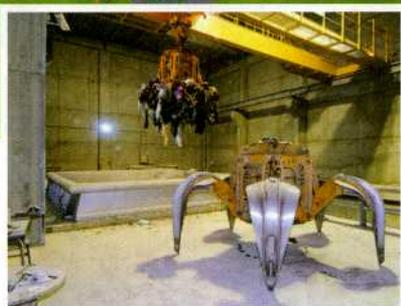
A l'aide du **grappin** 7, qui supporte à chaque prise 2 tonnes de charge, le **pontier** 6 brasse les déchets afin d'obtenir un mélange homogène favorisant une meilleure combustion.
