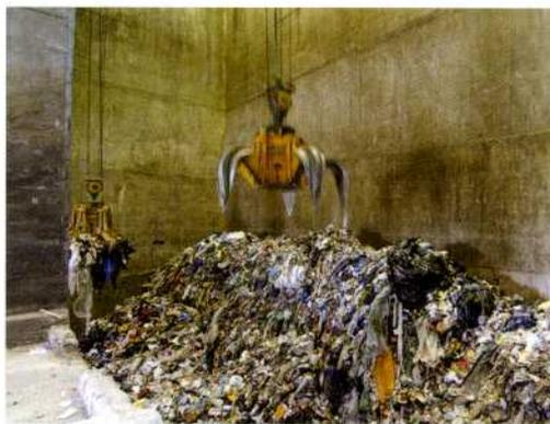
La capacité de la fosse principale 3 qui réceptionne les déchets a été renforcée. D'une profondeur de 18 mètres, elle permet de disposer de cinq jours d'autonomie en cas d'arrêt d'activité du site.
