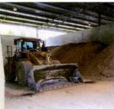
Les métaux récupérés sur la **plate-forme de traitement des mâchefers** 14 sont expédiés chez les recycleurs. Les mâchefers sont convertis en matériaux de remblaiement pour la construction de routes ou de parkings.
