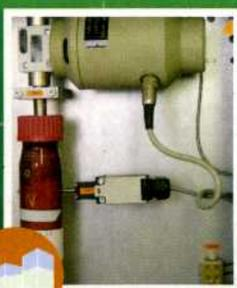
Placée dans la cheminée, une sonde prélève en continu des échantillons de fumée dans une cartouche de résine capable de fixer les dioxines et les furannes. Différents paramètres de fonctionnement de l'usine (débit et volume des gaz prélevés, températures des fumées et vitesse en cheminée), sont enregistrés toutes les 30 minutes sur une carte mémoire. Ces données permettent de calculer la concentration moyenne d'émission et de vérifier ainsi les normes de rejet
