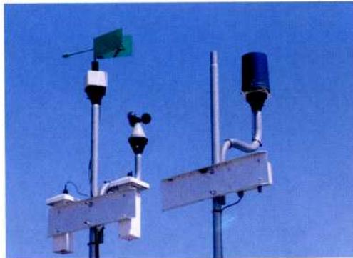
Une station météorologique, placée à proximité du site de Lasse, permet de valider en temps réel la force et la direction du vent et de connaître ainsi précisément, le modèle des dispersions des particules dans l'air.
