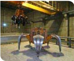
Le grappin : Il peut transporter jusqu'à 2 tonnes de charge à chaque prise. Il y a deux grappins sur le site qui sont utilisés l'un après l'autre, afin d'assurer en permanence l'alimentation du four !
