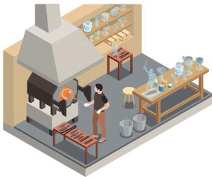
L'ensemble est chauffé à haute température (jusqu'à 1 500°C). L'ensemble prend ainsi la forme que l'on souhaite. Le verre est défini comme un matériau amorphe\* qui présente le phénomène de transition vitreuse : un passage d'un état rigide et cassant à un état plus souple et caoutchouteux en chauffant. La teinte du verre est obtenue par le mélange de différents oxydes (fer, cobalt, uranium, cuivre, chrome...) aux matières premières.
