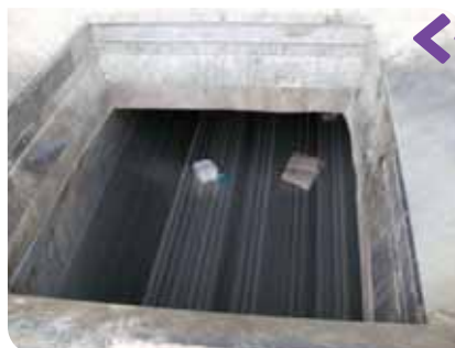
Le fond mouvant du semi permet d'étaler les OM et de les faire avancer jusqu'au fond du camion
