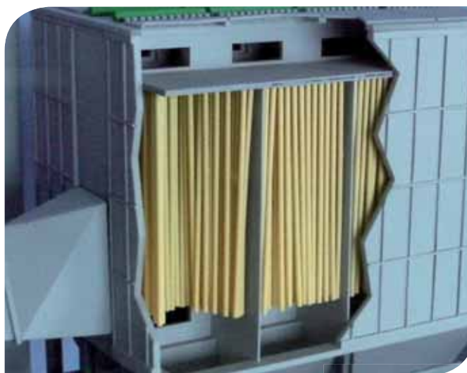
Le filtre à manche : 960 manches de 3 à 4 mètres de hauteur représentant une surface de filtration de 2000 m 2 .
