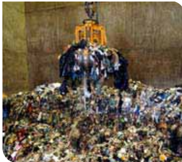
Le mur de Déchets : le pontier doit le plus possible brasser les déchets de la fosse et fabriquer ce que l'on appelle « un mur de déchets ». Ceci afin de laisser toujours la fosse la plus nette possible et de faciliter l'accès aux camions de déchets pour le déversement de leur chargement. « Ce sont surtout les adjoints de quart présents la nuit qui s'en occupent pour que les premiers camions de la matinée puissent décharger au mieux ».
