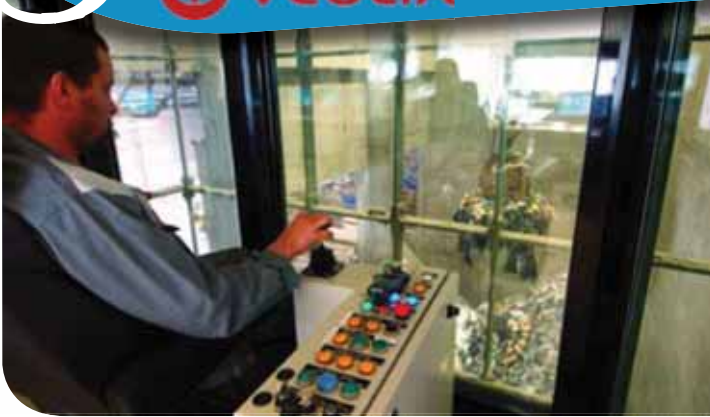
En surplomb de la fosse, l'adjoint de quart alimente le four en déchets à l'aide du grappin.
